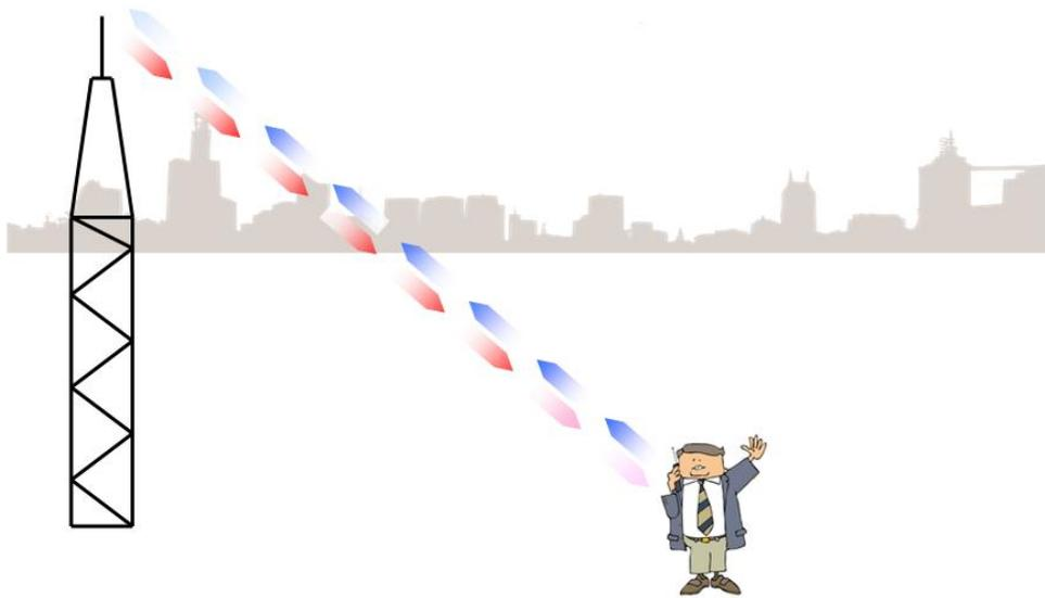
La **señal de radio** es más fuerte cerca de la antena, y **se debilita con la distancia** a la antena
