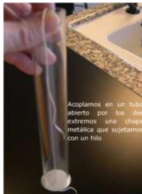
Una chapa inicialmente sujeta por un hilo, y sumergida en un líquido, se mantiene pegada al tubo al soltar el hilo.
