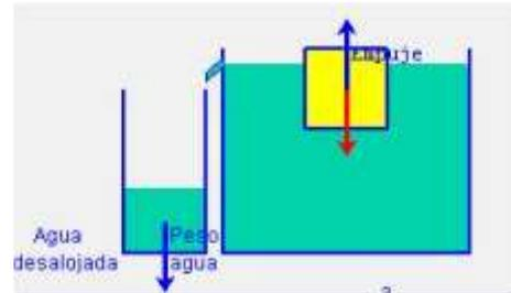
Desaloja igual volumen de agua que el volumen de la parte sumergida del cuerpo. Ésta agua pesa igual que el cuerpo.  $V_s = V_{\text{agua desalojada}}$ .
