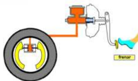
El circuito rojo tiene conectados tres pistones en los que se mueven tres émbolos. El émbolo de menor sección lo mueve el pie y los otros dos los acciona el circuito contra las mordazas que van en el interior de la rueda.
