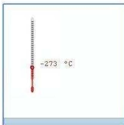
Suponemos el gas ideal encerrado en un recipiente tapado por un émbolo móvil. En su exterior actúa sólo la presión atmosférica, así que, a medida que la temperatura descende, la presión se mantendrá constante y el volumen irá descendiendo paulatinamente, de forma que, al alcanzar el cero absoluto, el volumen del gas ideal sería nulo.
