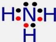
El átomo de Nitrógeno tiene 5 electrones externos. El átomo de Hidrógeno tiene 1 electrón externo. Para tener configuración del gas noble Ne, el Nitrógeno necesita ganar 3 electrones. Para tener configuración del gas noble He, el Hidrógeno necesita ganar un electrón. La solución está en unirse un átomo de Nitrógeno con 3 átomos de Hidrógeno. Así el Nitrógeno tiene 8 electrones y cada Hidrógeno 2 electrones en su última capa.
