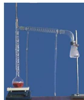
Las sustancias que componen una disolución mantienen diferentes temperaturas de fusión y ebullición. Esta diferencia se puede aprovechar para separar sus componentes. Arriba vemos un equipo de destilación preparado para extraer diferentes componentes de la disolución según su temperatura de ebullición. Obsérvese el serpentín intermedio, donde el vapor se condensa antes de llegar al erlenmeyer.
