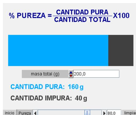
Ejemplo gráfico: Una sustancia con un 30 % de pureza, tiene en cada 750 g totales de sustancia. Calcular la cantidad de sustancia pura e impura.
