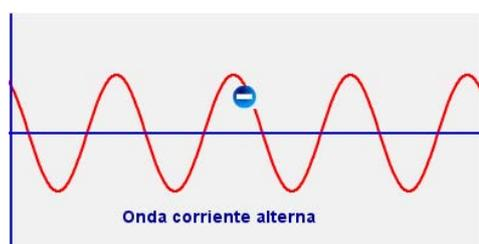
La corriente alterna superó las **limitaciones** que aparecían al emplear la corriente continua. La razón del amplio uso de la corriente alterna viene determinada por su facilidad con que se eleva su tensión, cualidad de la que carece la corriente continua.
