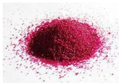
Cloruro de Cobalto(II) hexahidratado  $\text{Co}(\text{H}_2\text{O})_6\text{Cl}_2$
