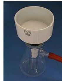
El filtrado para extraer partículas sólidas de un líquido se basa en que las partículas sólidas son mucho más grandes que las moléculas del líquido. En el laboratorio es frecuente utilizar el conjunto de la figura: sobre un embudo Büchner de porcelana se dispondrá el filtro. El líquido caerá al kitasato dispuesto bajo el embudo. A la derecha del kitasato vemos la conexión con una trompa de agua. El vacío que ésta crea produce una succión sobre el líquido, acelerando el filtrado.
