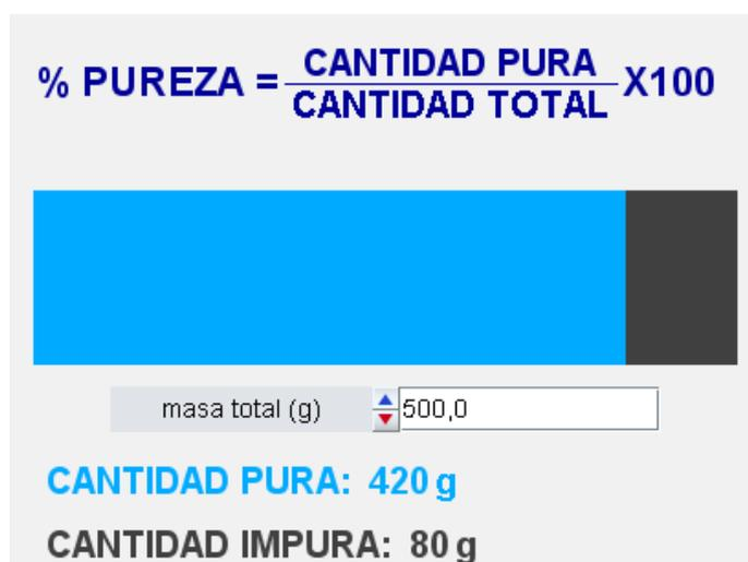
Ejemplo gráfico: Una sustancia con un 80 % de pureza, tiene en cada 200 g totales de sustancia. Calcular la cantidad de sustancia pura e impura.
