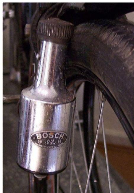
En la segunda imagen vemos la dinamo de una bicicleta, accionada por el giro de la rueda. En este caso los bornes de contacto del inducido con el circuito exterior están dispuestos de forma que cambien su polaridad cada media vuelta. De esta forma se consigue que el sentido de la corriente sea siempre el mismo. Las dinamos producen **corriente continua**.
