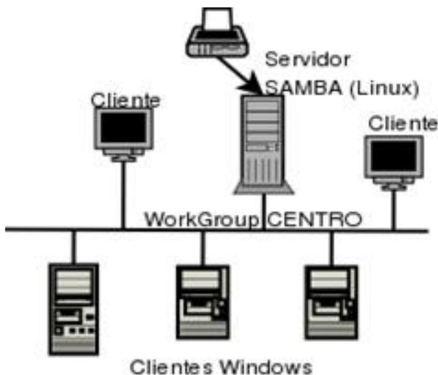
Una configuración de red simple con un servidor Samba.
