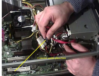
Fig. 13-5: Conector sonido CD-ROM
