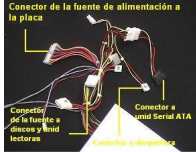
Fig 9 Conectores de la fuente a la placa
