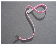
Fig 12. Cable de datos Serial ATA.
