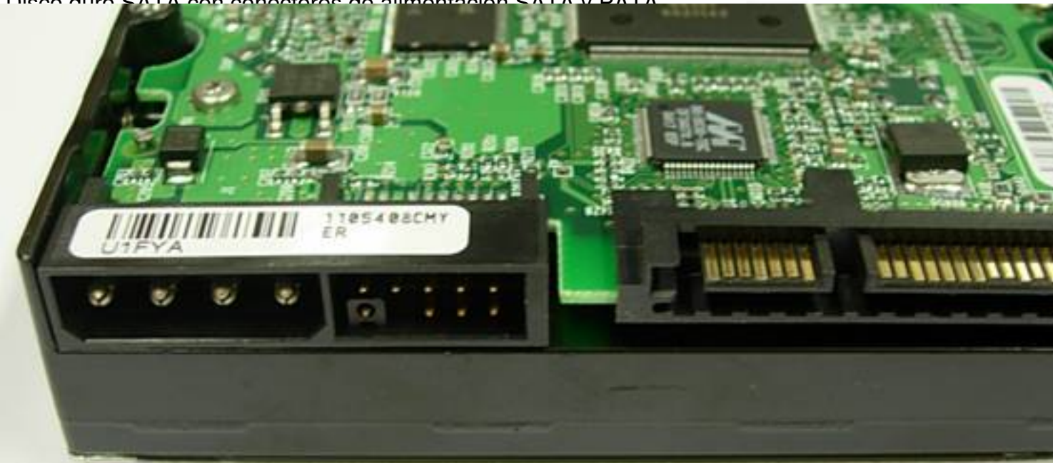
Disco duro SATA con conectores de alimentación SATA y PATA
