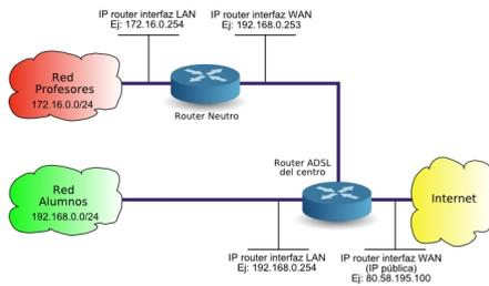
Hay que tener en cuenta que la Interfaz WAN del router neutro deberá ser configurada con IP estática del rango de alumnos y que la puerta de enlace de dicha interfaz WAN, deberá ser la IP LAN del router ADSL.
