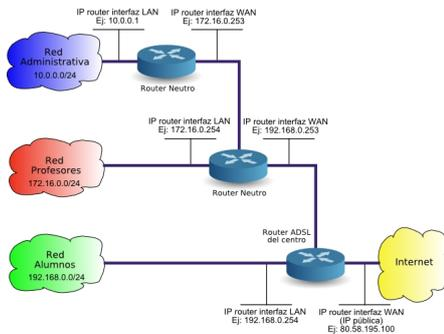
Para que esta separación con un router neutro sea **efectiva**, es necesario que exista una separación física de los PCs de las distintas redes en diferentes switches. Si fuera complicada o muy costosa la separación física de las redes debido a que implicaría realizar varios tendidos de cableado de red, existe la posibilidad de crear redes virtuales (ver artículo 'Separando la red con VLANes' en este mismo monográfico)
