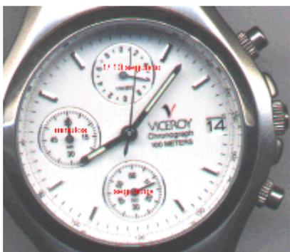
Los instrumentos analógicos suelen tener una escala con divisiones frente a la que se mueve una aguja. La aguja pasa frente a los infinitos puntos de la escala. Al alcanzar el valor que mide el aparato la aguja se detiene en un punto que puede coincidir más o menos con una división de la escala. Esa división es la que leemos nosotros en el acto de la medida directa.
