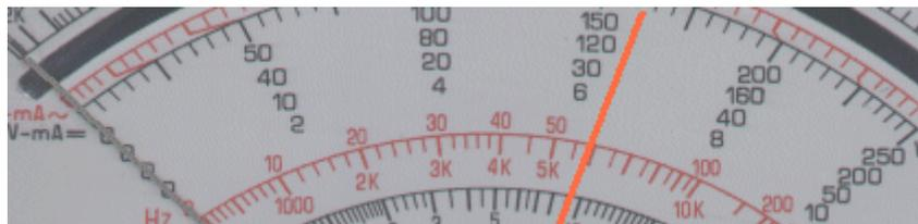
24. ¿Qué escala del polímetro usarías para medir un voltaje de 8 V ?
