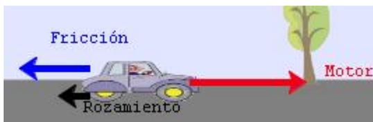
La fuerza del motor en realidad se transmite a través de las ruedas como un empuje del suelo hacia atrás. La reacción, que empuja el coche hacia adelante, es la que está representada en rojo como fuerza del motor.
