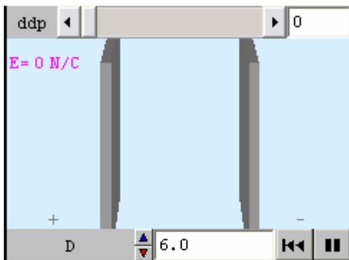
En la escena adjunta vemos un condensador, sistema formado por dos placas conductoras de cargas iguales, pero de distinto signo, separadas por un material aislante o el vacío. En su interior la intensidad de campo es aproximadamente uniforme, igual en todos los puntos. Puedes alterar la diferencia de potencial entre las placas o la distancia entre ellas.
