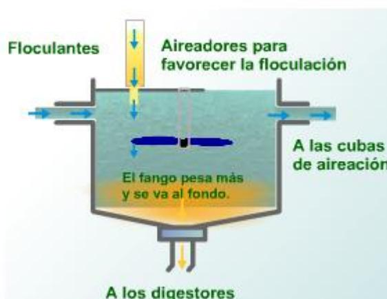
Tras un periodo de tiempo determinado, se recoge el agua de la parte superior del decantador y esta, ya libre de esos materiales, se canaliza hasta la siguiente fase del proceso.
