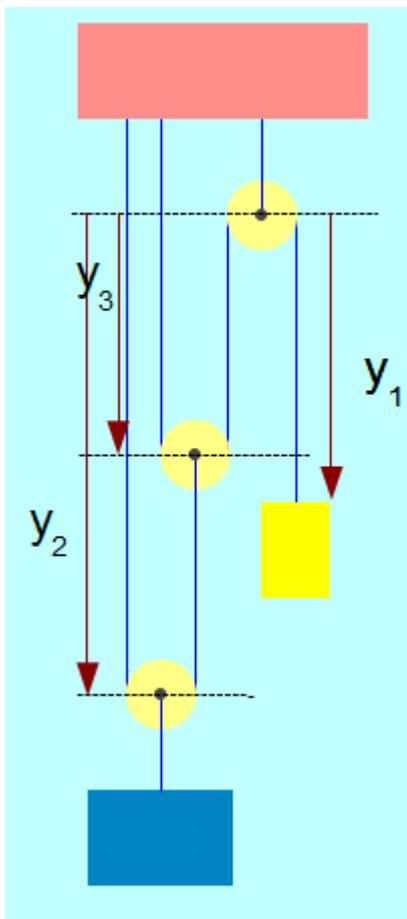
Como la masa de las poleas se considera despreciable (es decir, nula) el producto de su masa por la aceleración será nulo y por tanto, las ecuaciones que se les aplican siguen siendo las mismas y se obtiene el mismo resultado  $T=2T_1$ ,  $T_2=2T_1$  y  $T_3=4T_1$ .
